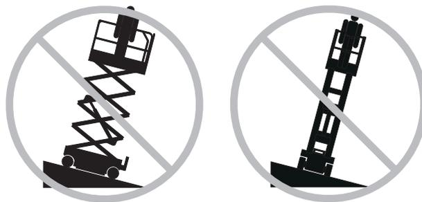
Verlassen Sie sich bei der Orientierung nicht auf den Neigungsalarm. Der Neigungsalarm am Fahrgestell ertönt, wenn die Maschine auf abschüssigem Gelände steht.
